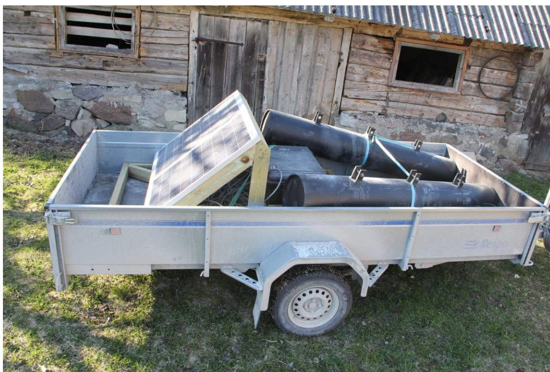
Joonis 18. Täisvarustuses hülgepeleti sõiduauto kerghaagisel (pontoonid tuleb kerghaagisele mahtumiseks lahti ühendada).
