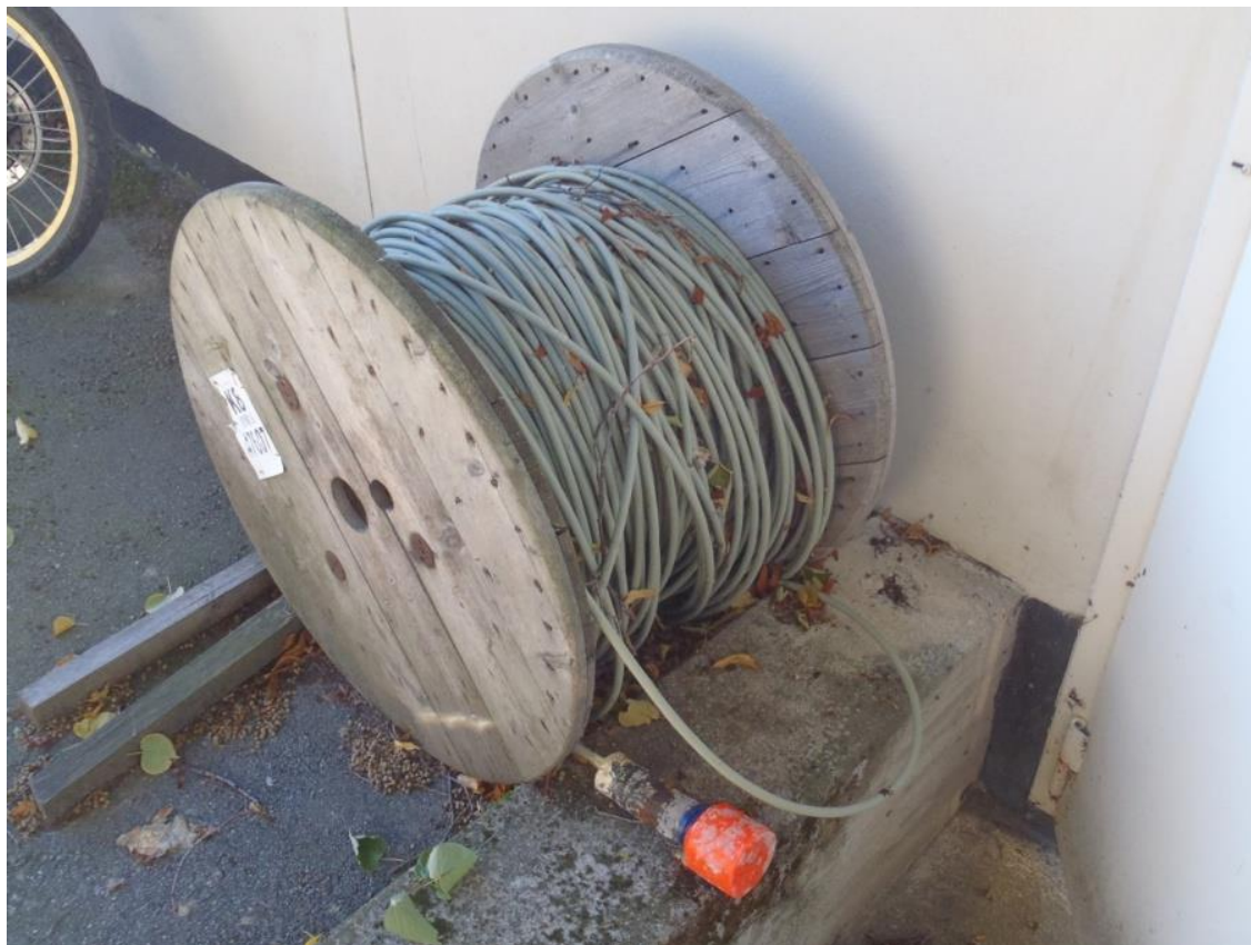
Joonis 14. Kaldale asetatava Lofitech'i peleti 400 meetri pikkuse juhtmega valjuhääldi. Selline lahendus võimaldab vältida peleti tormikahjustusi ja võimaldab pidevat akude laadmist 220 V toitest.
