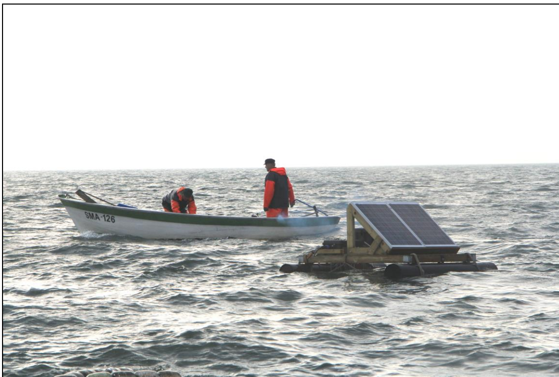
Joonis 20. Päikesepaneeliga varustatud hülgepeleti Liivi lahes Sõrve piirkonnas (katsetused räime- ja tuulehaugipüügil 2013 kevadperioodil).
