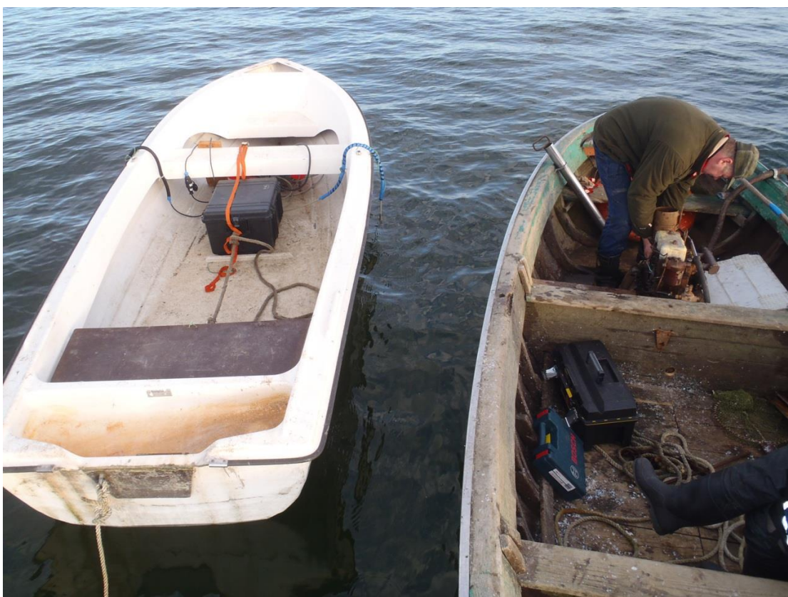
Joonis 19. Paati paigaldatud pideva 220 V toitega hülgepeleti Sõrves (paadist vasakul toitekaabel, paremal juhe peleti valjuhääldisse).
