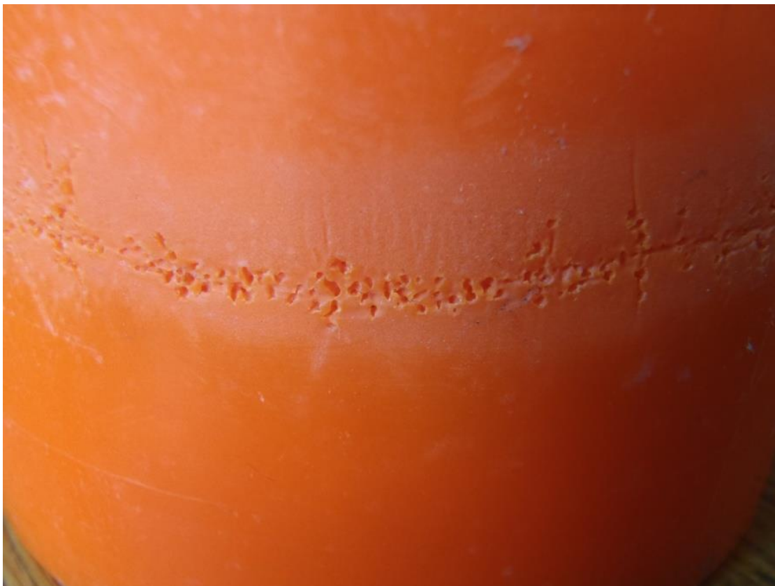
Joonis 26. Kavitatsioonist kahjustatud hülgepeleti valjuhääldi lähivaates.
