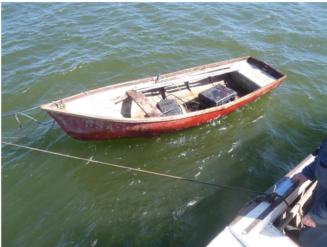
Joonis 15. Nasval paigaldati peleti (vasakpoolne kast) ja kaks 120 Ah akut (parempoolne kast) paati ning veeti peleti sellega regulaarselt sadamasse akude laadimiseks.
